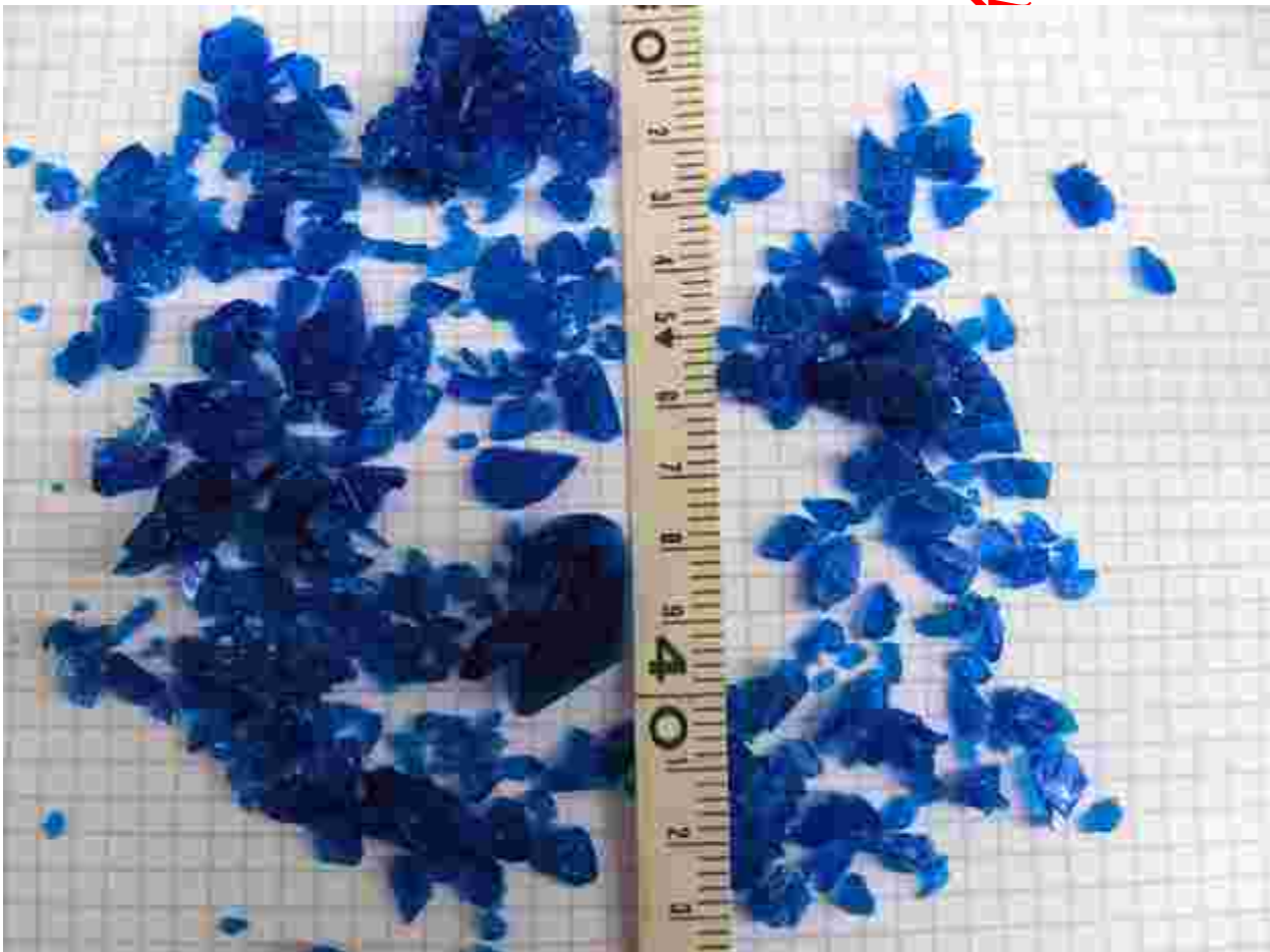
Bodensatz aus Gefäß Nr.2 (ohne Profikalk) , deutlich sichtbare, große und regelmäßige Kristalle
