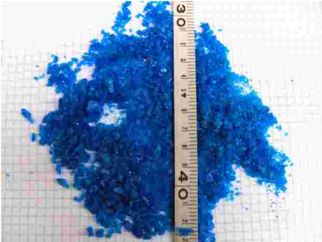
Bodensatz aus Gefäß Nr.1 (Mit Profikalk) deutlich sichtbare nichtkristalline Ausbildung
